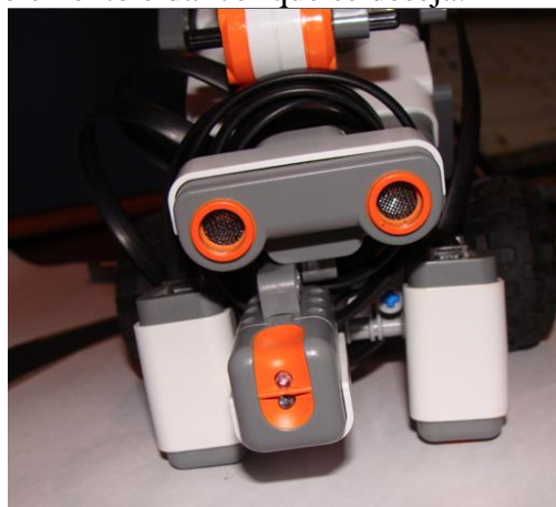
Figura 7 – Disposição dos sensores responsáveis pela rotina de captura da bola.
