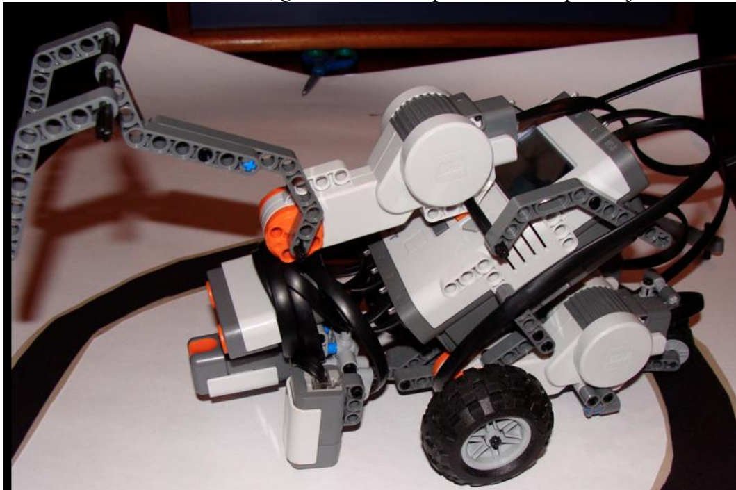
Figura 1 – Robô LEGO MindStorms NXT utilizado com modelo de controle Fuzzy.
